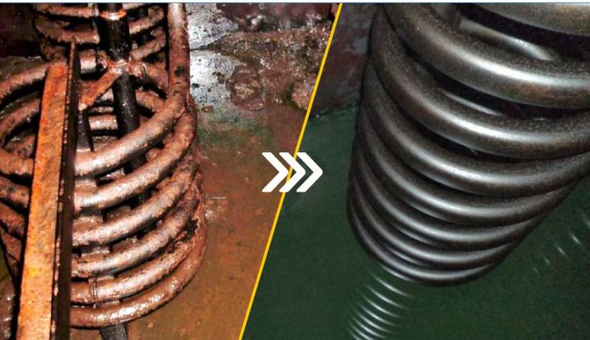
La présence d'oxygène et d'eau de mer contribuent à la formation de boues hautement corrosives, déstabilisant davantage le combustible. Ces boues se forment souvent dans les soutes de stockage lorsque différents types de carburant sont mélangés. Combinées avec de l'eau salée, les boues forment un cocktail corrosif, ce qui entraîne des problèmes plus fréquents d'entretien du système d'alimentation en carburant et de combustion, ainsi qu'une augmentation de la corrosion.
