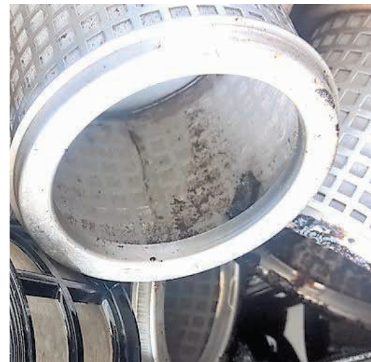
Filtre à gasoil XBEE, après un mois de traitement
