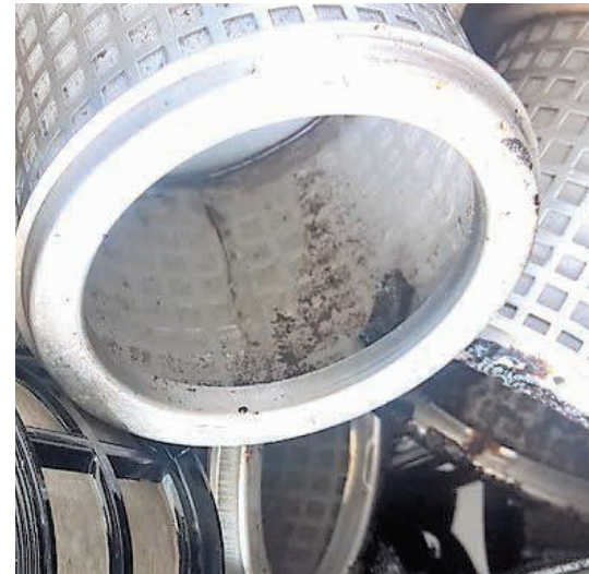
Filtro de gasoleo XBEE, al cabo de 1 mes
